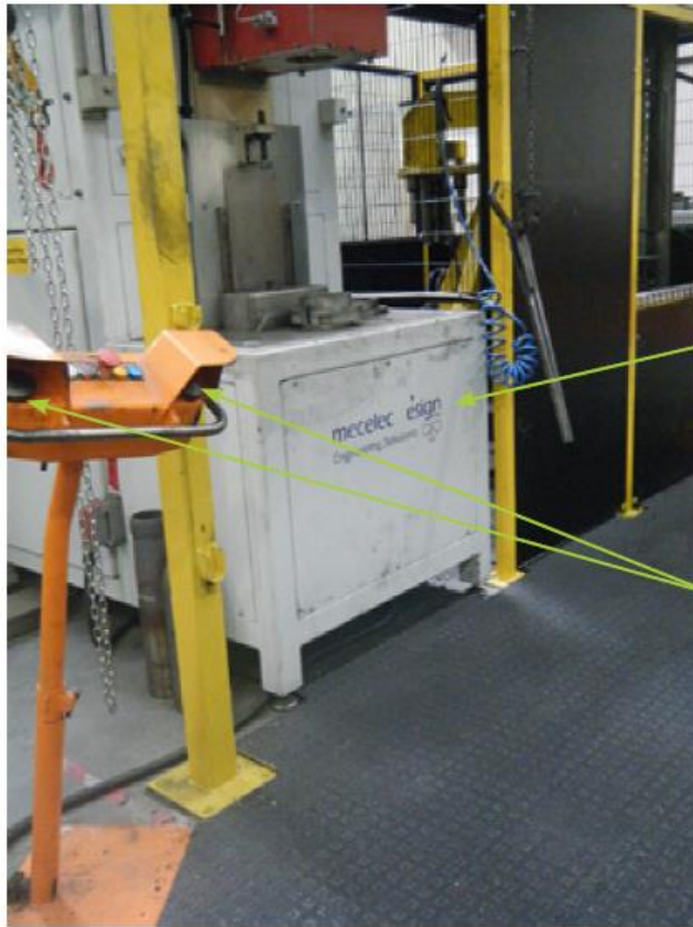
Figuur 9.4 — Met twee handen te bedienen bedieningstoestel, gebruikt om de werknemer gescheiden te houden van inductief verwarmingstoestel
